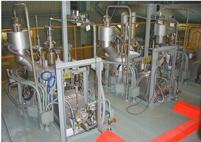
(a) ナトリウム中内圧クリープ試験装置の外観
