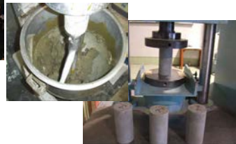
灰化樹脂のコンクリート混練固化調査
