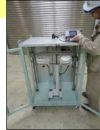
小口径配管の縦割工具の試作
