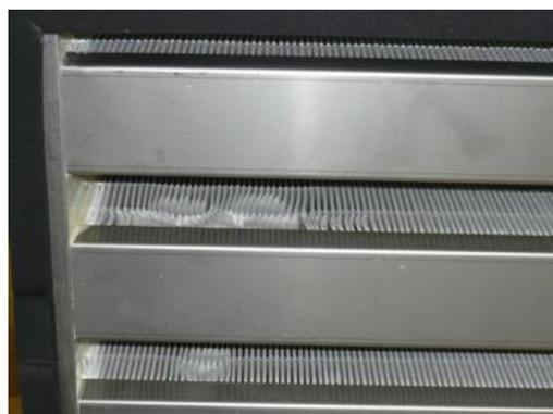
写真 2.8.2-1 蒸気水分により目詰まりした HEPA フィルター
