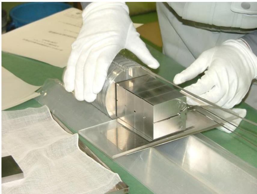
写真 2.3-2 破壊靱性評価キャプセル照射試料組込作業
