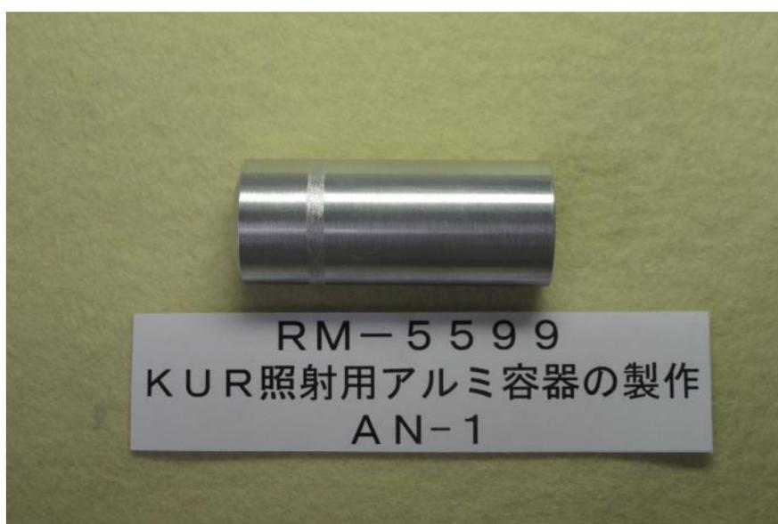
写真 2.3-1 Mo/Tc 製造実用化技術開発 KUR（京大炉）照射用アルミ容器
