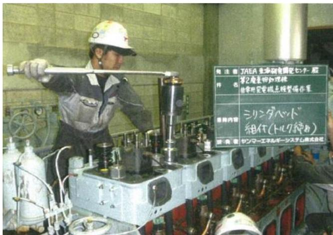
写真 2.11.6-2 シリンダーヘッドの組付け状況
