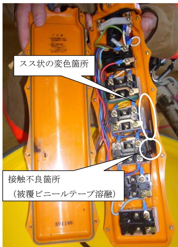
写真 2.8.6 操作用ペンダントスイッチ内部の状況
