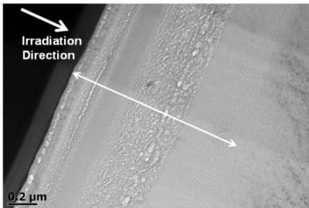
**Damage layer : ~1 μm**
