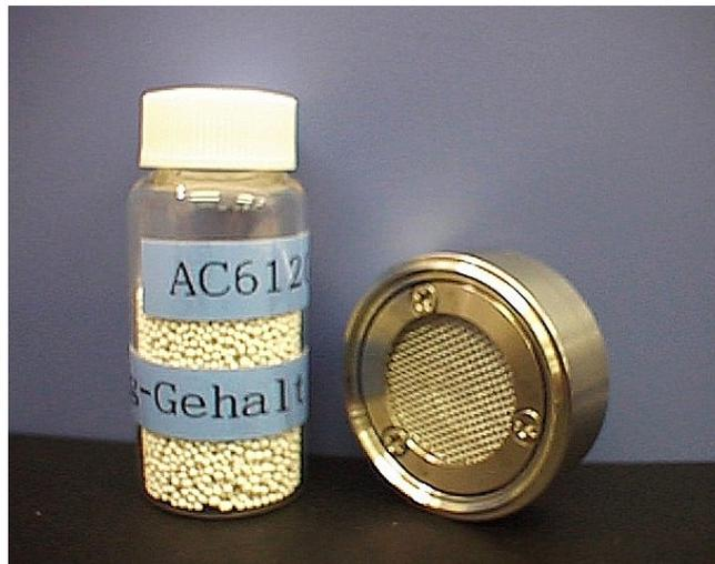
図4. 7-2 ヨウ素捕集試験に用いた吸着剤 (AC6120) とカートリッジの外観
