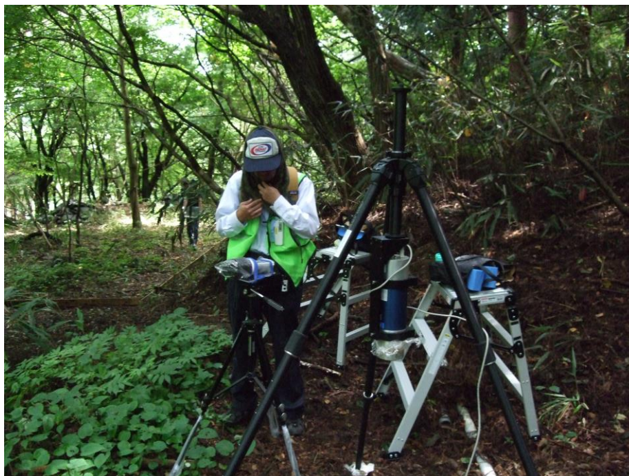
図 2-3. 山林内でのガンマ線波高分布の測定風景
