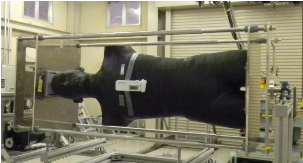
図 2-4. 回転照射装置に設置した RANDO ファントムと個人線量計
