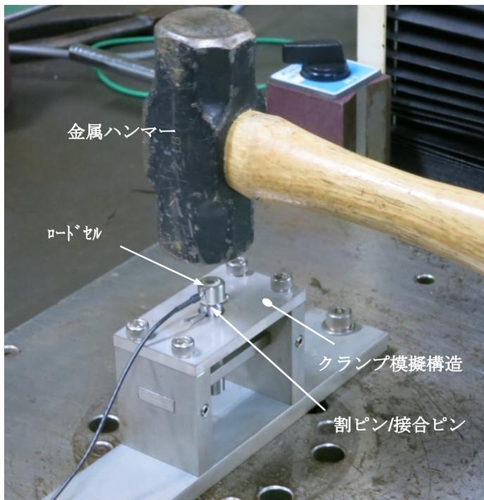
金属ハンマーでの打撃（先端に小型ロードセルをセット）
