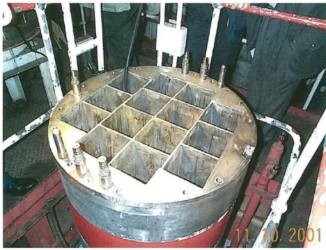
図 4.2-1 BWR 燃料用マルチエレメントボトル 図 4.2-2 補強された損傷 BWR 燃料集合体 出典) A .H. C. Callaghan, et al., The Management of Non-standard, Failed and Damaged Oxide Fuels at Sellafield, © British Nuclear Group, (2005).
