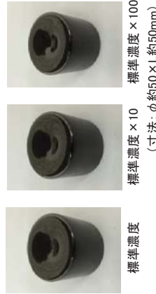
図4 ガラス試験片の均質性評価 （目視観察）
