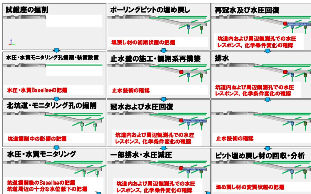
図 3.3-1 再冠水試験の流れ
