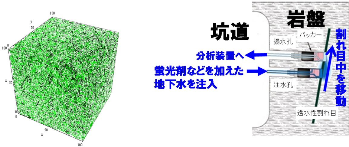
図 2.2-2 物質移動モデル化技術の開発
