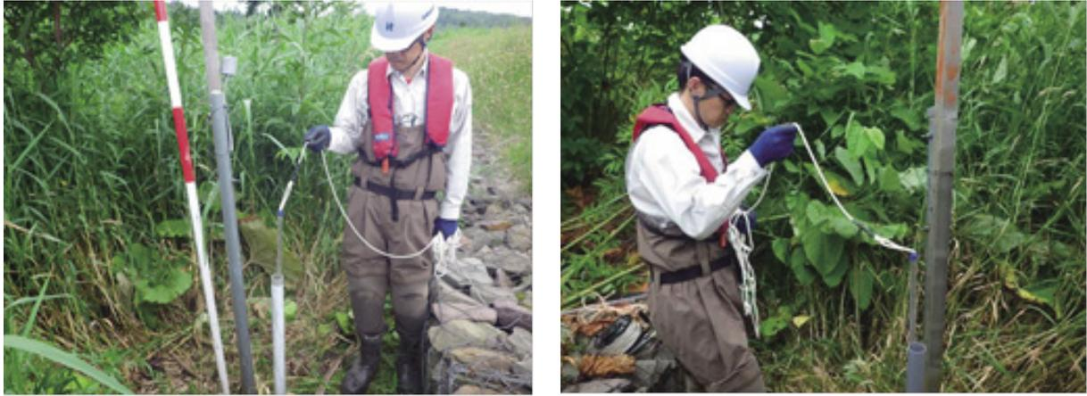
写真 10 掘削土（ズリ）置場周辺の地下水の採水状況
