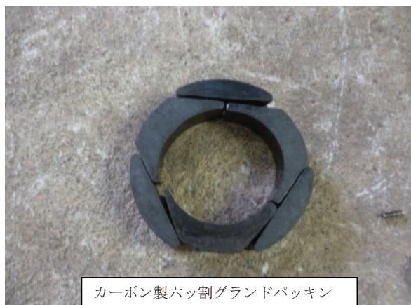
摩耗が確認されたグランドパッキン
