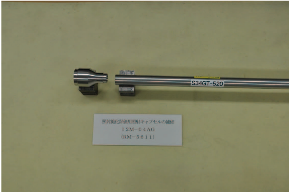
写真 2.3.1-1 照射脆化評価用キャプセルのレジューサ部
