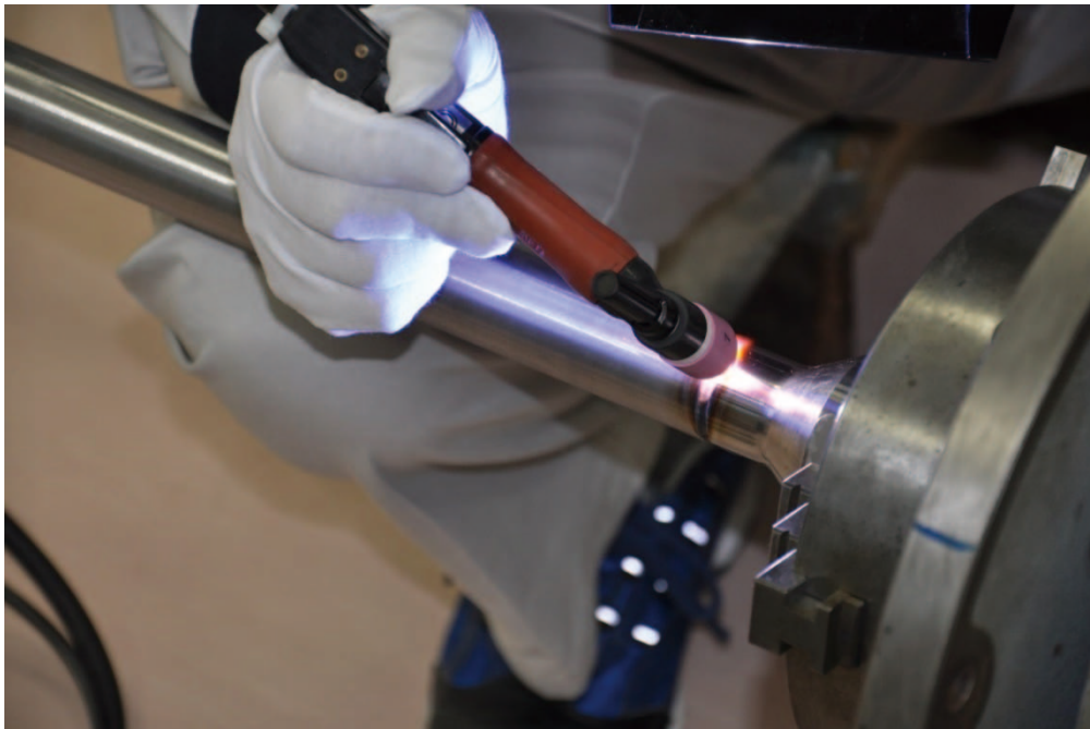
写真 2.3.1-2 照射脆化評価用キャプセルのレジューサ部改造作業
