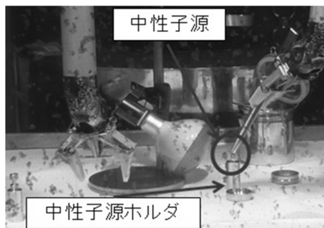
図 3.2 中性子源の組み立て作業
