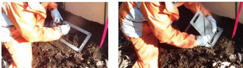
図 3.1-33 スクレーパープレートによる土壌採取
