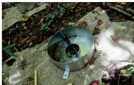
図3.1-26 林内に設置したモーガン型スプラッシュカップ（上；全景、下；拡大写真）
