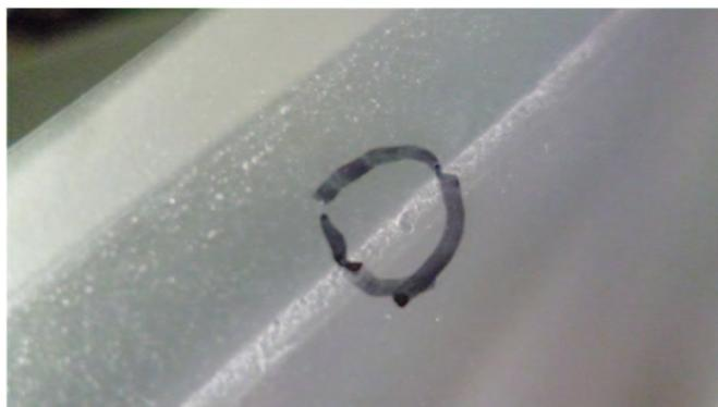
(c) No. 11 小穴が開いてガスが漏れた例
