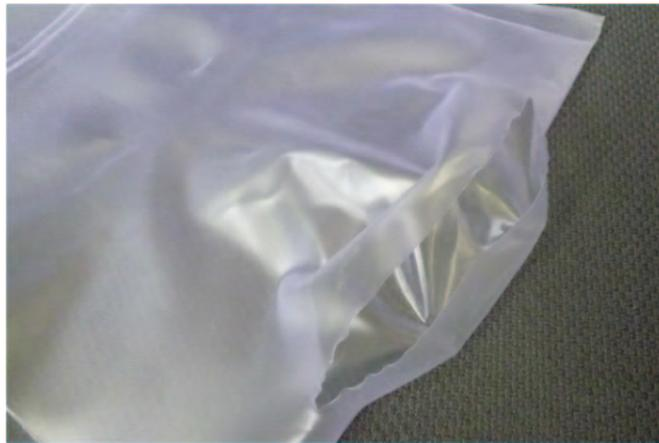
(b) No. 10 直線上に破損（破裂）した例
