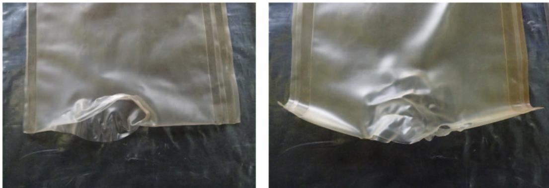
(b) 破裂後の破損部の状態
