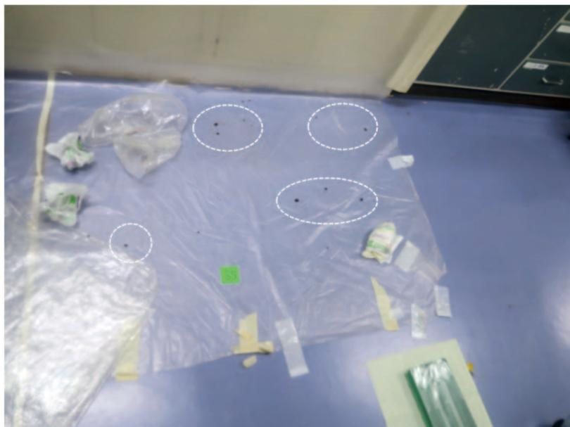
(b) フード手前床養生シート上の飛散物（点線枠内の黒いかげら状のもの）
