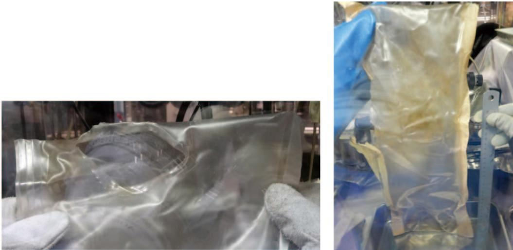
(b) 事故後の貯蔵容器内から取り出した PVC バッグの破損状態
