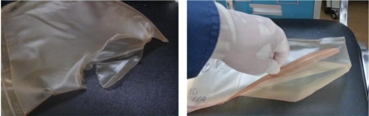
(a) 破裂試験後の PVC バッグの破損状態 No. 4 (左：二重目、右：一重目)
