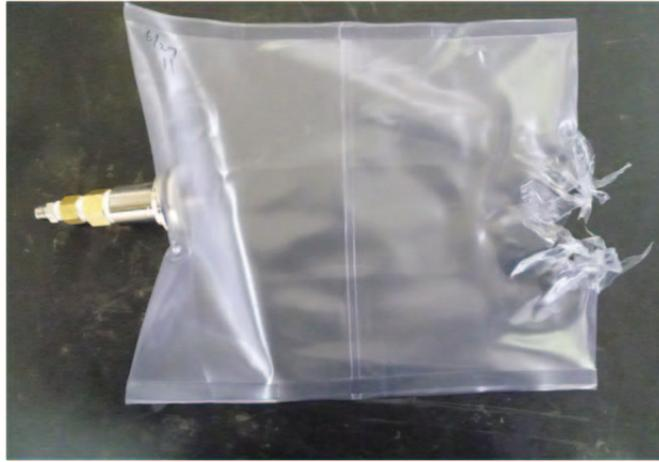
(a) No. 9 放射状に破損（破裂）した例
