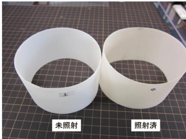
Fig. 4-3 未照射 (左) と照射後 (右) のポリ容器の外観写真
