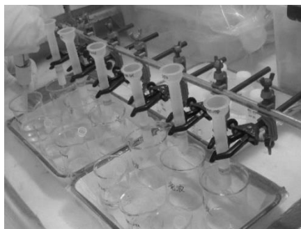
固相抽出樹脂を用いた化学分離の様子
