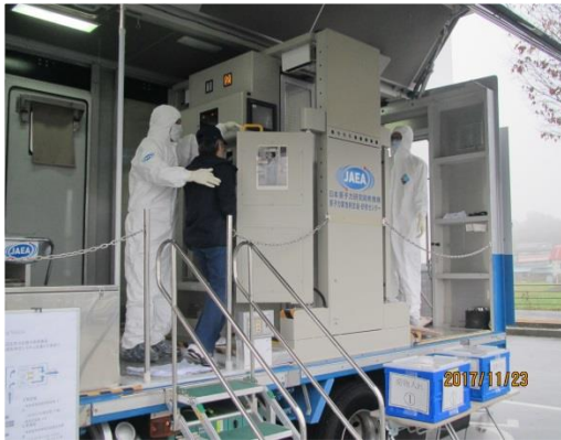
写真3.1-18 体表面測定車での汚染検査
