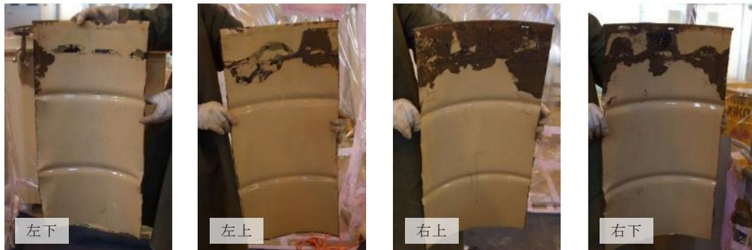
ドラム缶内面の腐食状況
