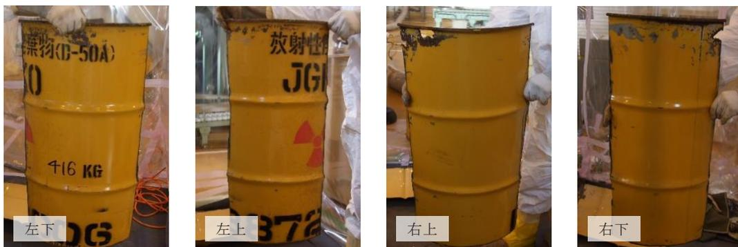
ドラム缶外面の腐食状況
