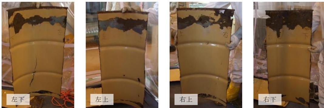
ドラム缶内面の腐食状況
