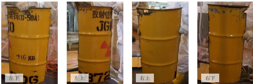
ドラム缶外面の腐食状況
