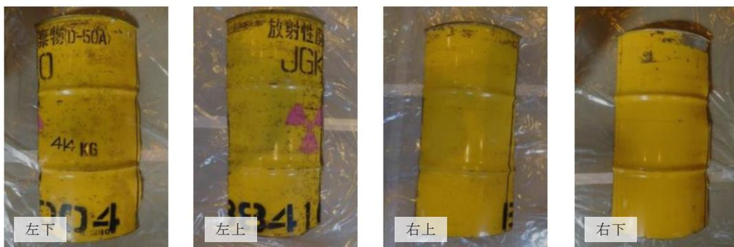
ドラム缶外面の腐食状況
