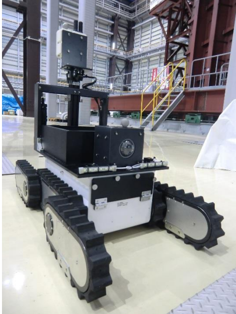
(1) J-11 偵察用ロボット (プラットフォーム部) (偵察機材は次年度整備予定)
