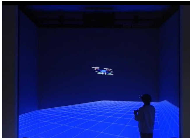
図 3.1.2.2-2 3次元可視化システムを利用したロボット（マルチコプタ）操縦の様子
