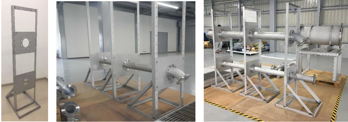
図 3.2.2-3 配管型試験場の構成例
