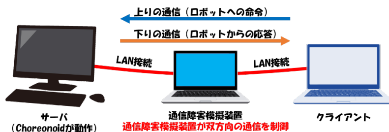
図 3.1.2.4-1 通信障害模擬装置使用時のシステム構成例
