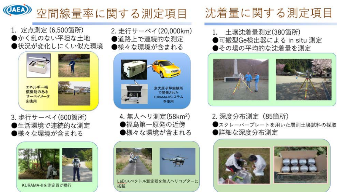
図 6.2-1 マップ事業における空間線量率及び土壌沈着量に関する測定項目とその概要 6-3)
