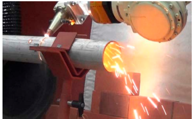
図 2.3.2-3 レーザー切断時の状況
