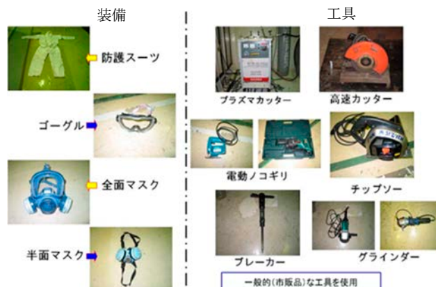
図 2.6.1-13 解体作業時の装備及び工具類
