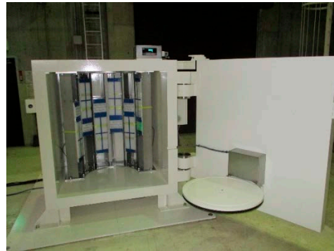
遮へい体内部
