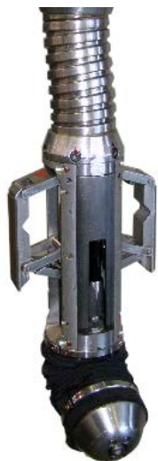
高圧水式洗浄（槽内のスラッジ等の除去） （濃縮ウラン溶解槽のスラッジ除去装置）
