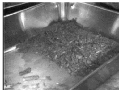
高圧水式洗浄（槽内のスラッジ等の除去） （濃縮ウラン溶解槽のスラッジ除去装置）
