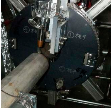
図 2.3.2-6 狭隘部対応切断ヘッド駆動装置外観
