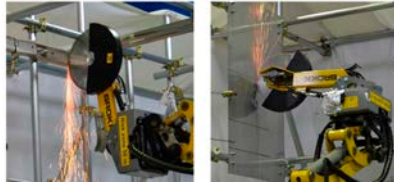
図 2.2-3 切断ツールを装備した 小型重機の切断能力確認試験
