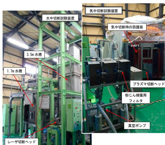
写真 2.3.2-2 粉じんデータ取得のための気中及び水中切断装置
