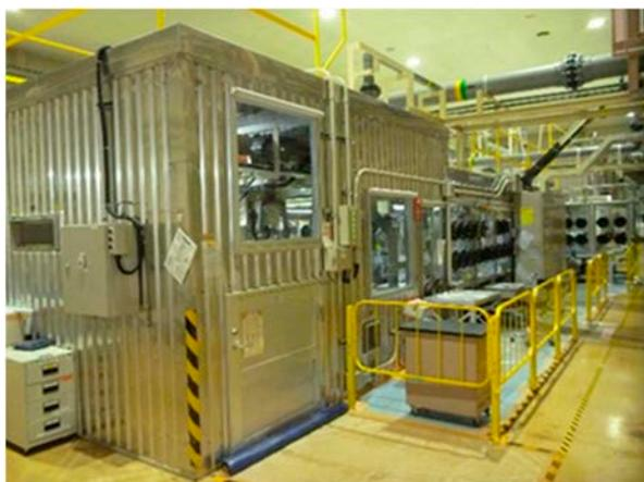
写真 2.6.1-1 分解設備 (ハウス搬入部)
