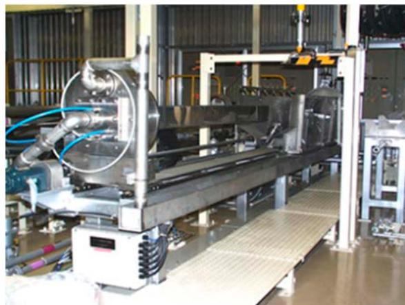
写真 2.6.1-2 大型部品除染装置 (ケーシング用)
