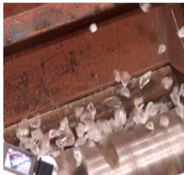
写真 2.2.1-2 破碎機によるアクリルパネル等の破碎試験
