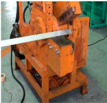
写真 2.2.1-1 油圧シャーによる等辺アングル・平板等の細断試験
