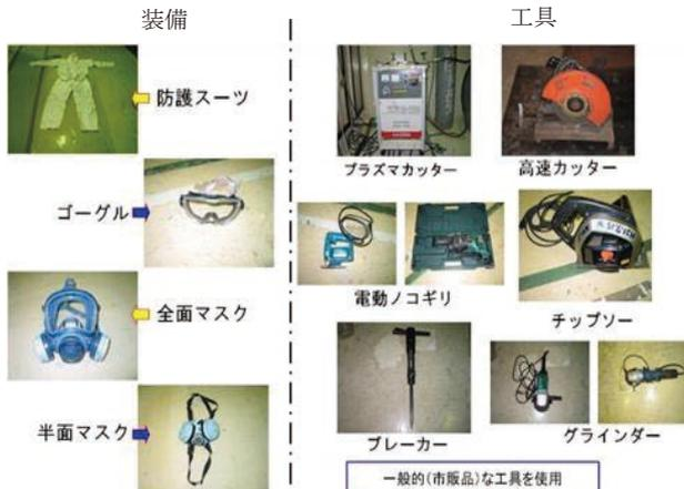
図 2.6.1-7 解体作業時の装備及び工具類
