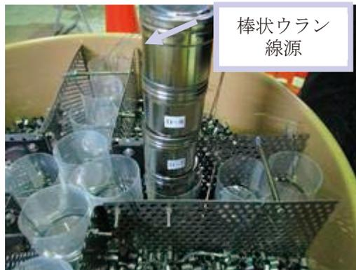
写真 3.5-2 模擬ドラム缶に配置した線源
