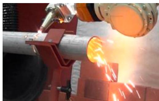
写真 2.3.2-1 レーザ切断工法による配管材の切断(例)
