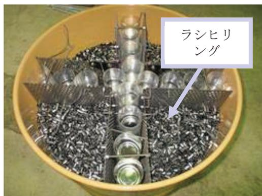
写真 3.5-1 模擬ドラム缶への充填物
