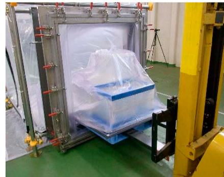
写真 2.2.1-3 フォークリフトによる大型機器類のバッグアウト試験
