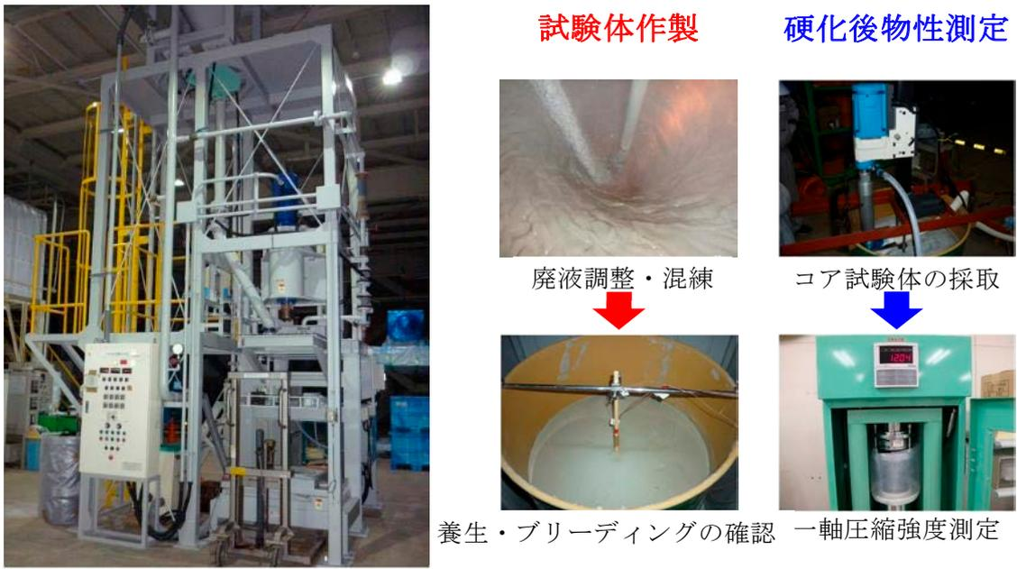
実規模セメント混練試験装置の概観
