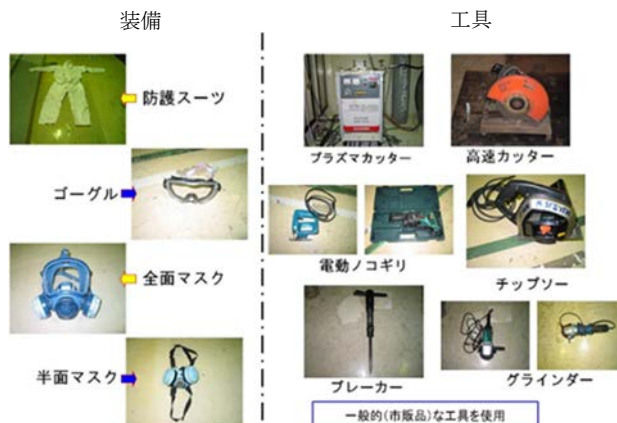
図 2.6.1-7 解体作業時の装備及び工具類
