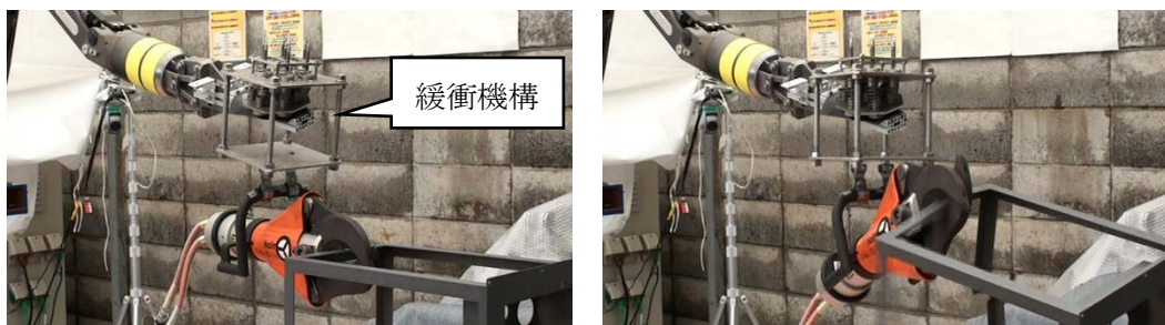
図 2.2-3 緩衝機構を備えた油圧カッターを用いた切断試験
