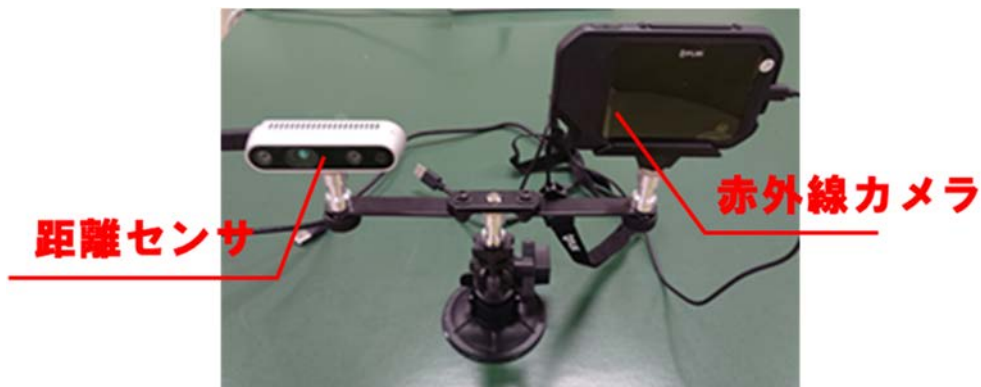
図 3-1 距離情報+温度情報の同時撮影システム
