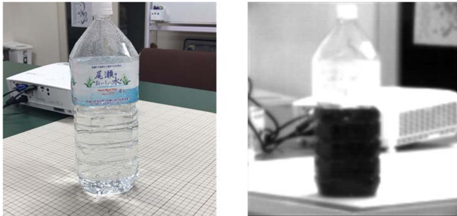
図 3-3 近赤外カメラから得られる水の画像の例 （左：可視光画像、右：近赤外画像）
