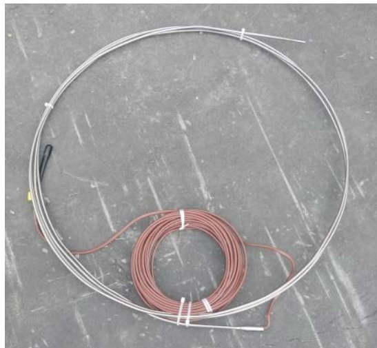
図 3.2-8 温度計 (熱電対) の外観写真
