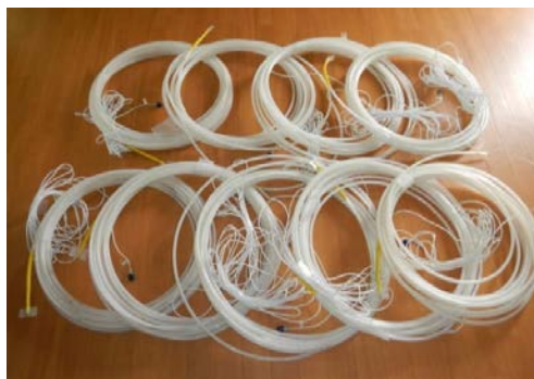
図 3.2-5 サイクロメータの外観写真
