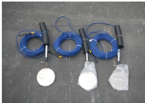
図 3.2-1 土圧計（振動弦式）の外観写真
