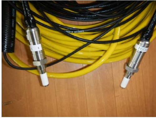
図 3.2-4 湿度計の外観写真
