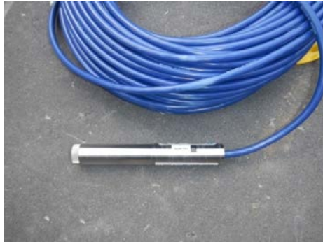
図 3.2-2 間隙水圧計（振動弦式）の外観写真
