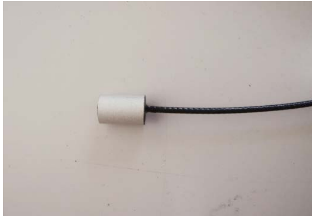
図 3.2-9 白金電極の外観写真
