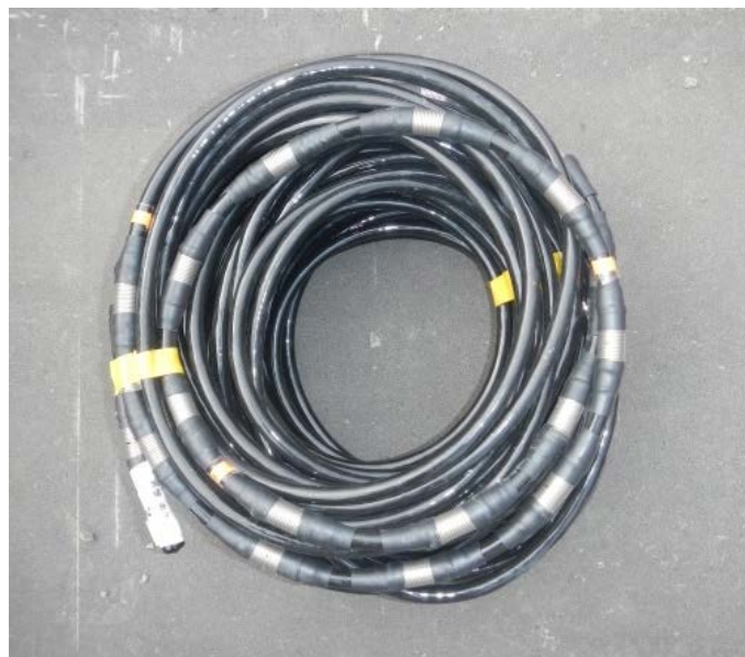
図 3.2-11 比抵抗トモグラフィ用の電極の外観写真
