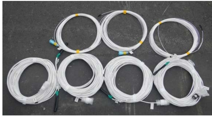
図 3.2-10 炭素鋼電極の外観写真
