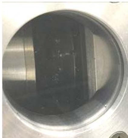
図 3.2.2-10 チョッパの外観（窓の奥、スリットが手前側に見える。）
