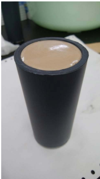
写真 3.2-7 空気中・室温条件下で作製した試料 7 日間、空気中（100%RH）、室温条件下で養生後の様子（試料 No. 2）
