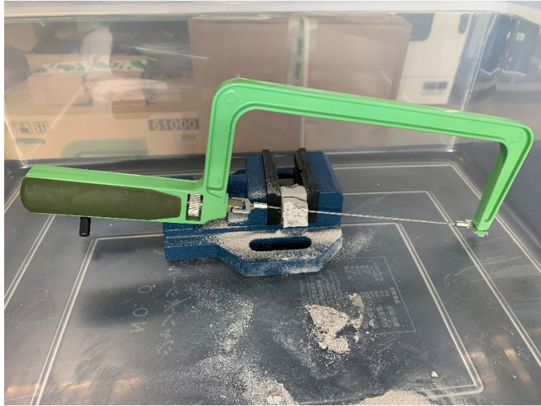
図 3.2-11 ダイヤモンドソーによるジオポリマー試料切断の様子
