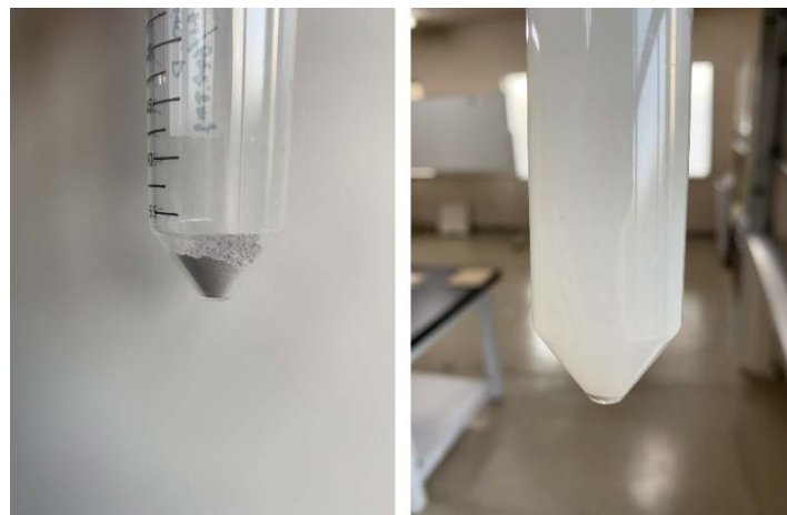
図 3.2-15 機械切断で発生したジオポリマー粒子とその粒子の懸濁液の様子
