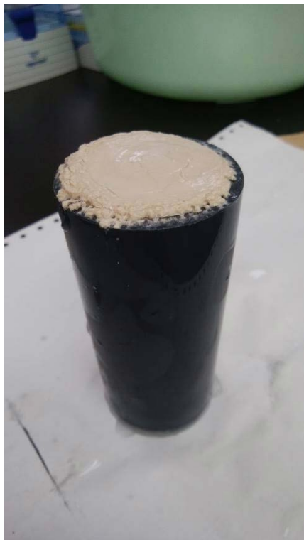
写真 3.2-10 水中・50℃条件下で作製した試料 7日間、水中・50℃条件下で養生後の様子（試料 No. 5）
