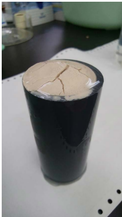
写真 3.2-8 水中・室温条件下で作製した試料 7 日間、水中・室温条件下で養生後の様子（試料 No. 3）
