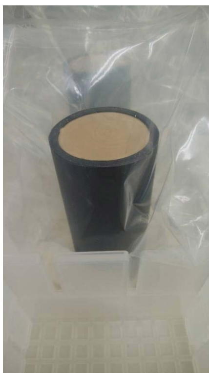
写真 3.2-2 空气中・室温条件下で作製した試料を空气中（100%RH）・室温条件下で養生および保管する様子（試料 No. 1、2）
