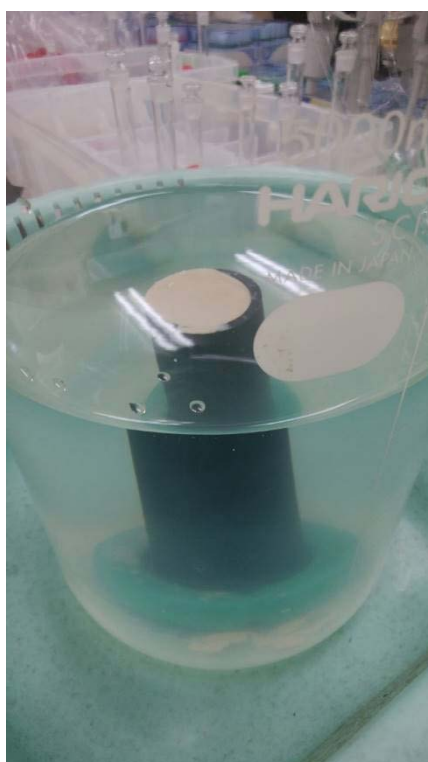
写真 3. 2-4 水中・室温条件下で作製した試料を 水中・室温条件下で養生する様子（試料 No. 3）
