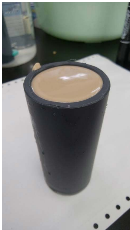
写真 3.2-5 空气中・室温条件下で作製した試料
