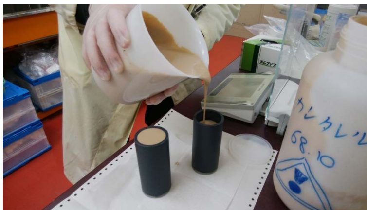
写真 3.2-1 空气中・室温条件下での試料注入の様子（試料 No. 1、2）
