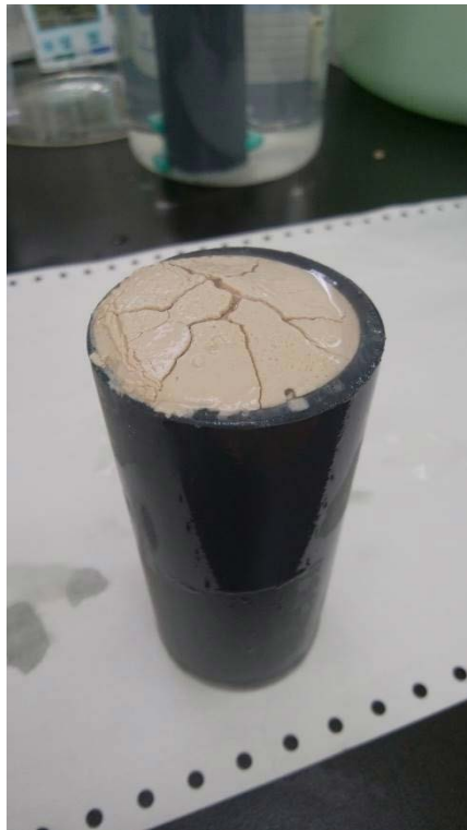
写真 3.2-9 水中・室温条件下で作製した試料 7日間、水中・室温条件下で養生後の様子（試料 No. 4）
