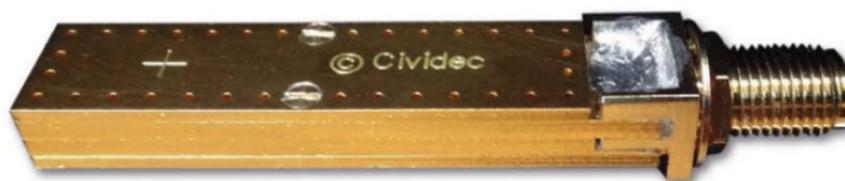
図 3.1.2-3 Cividec 社製熱中性子測定用ダイヤモンド検出器 B6-C の外観図
