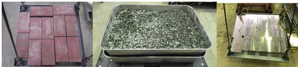
図 3.3.1-8 供試体：コンクリート製レンガ（左）、砂利（中）、ステンレスブロック（右）
