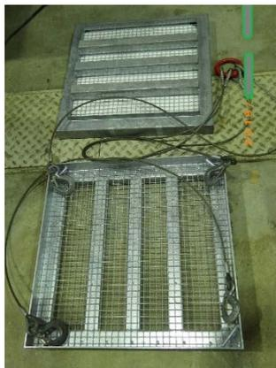
図 3.3.2-7 供試体設置用治具
