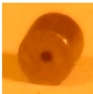
図 9.2 照射済み燃料コンパクト試料の外観
