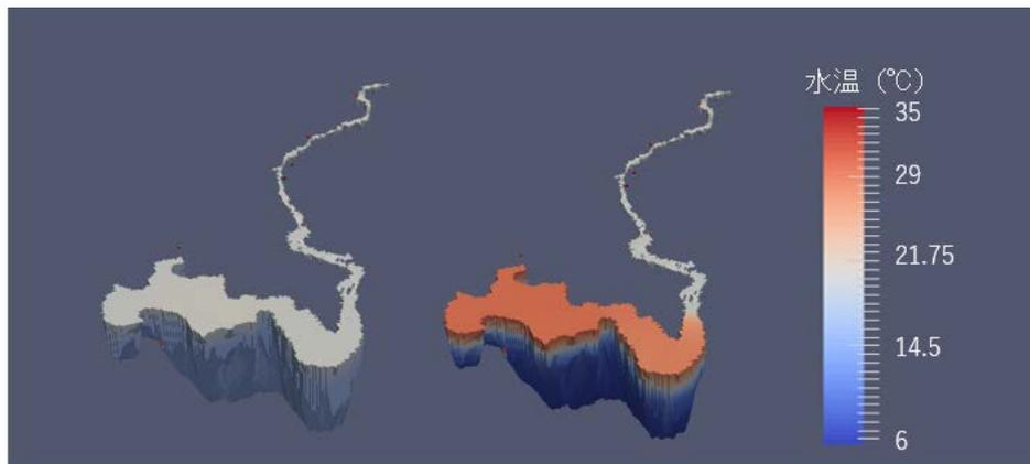
図2 水温が低いダム湖に水温が高い河川水が流れ込んだ際のシミュレーションによる温度分布の結果。これまでの方法だと左図のように上層と下層の水が混ざり、水温の成層化は見られないが、水深を考慮した圧力等の補正を行うことで、右図のように水温の成層化を再現することができる。
