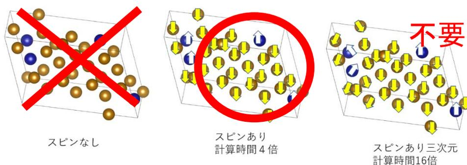
図1 クロム 10%鉄合金における磁性の扱いの概略
