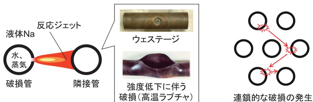
図 1 反応ジェット、隣接管の損傷、及び破損伝播
