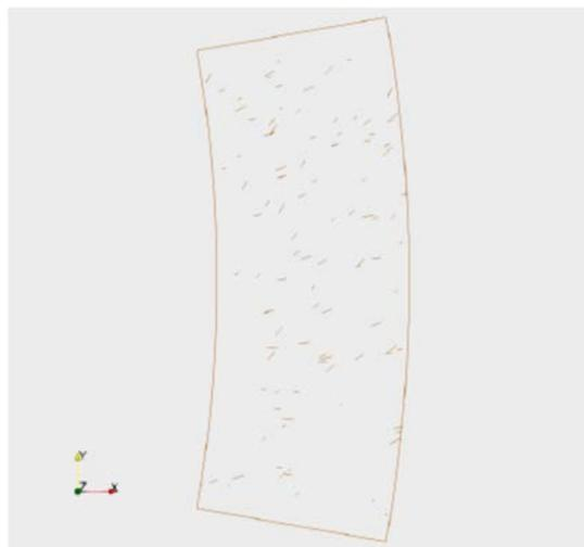
図 1-2 被覆管モデルにおける複数の亀裂の配置例
