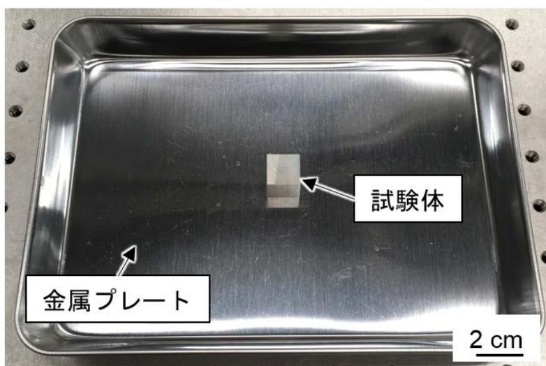
図 3.1.1-1 試験体と微粒子捕集用の金属プレート
