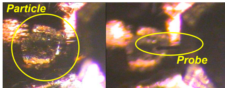
図 3.2.2-13 図 3.2.2-12 に示す測定実施時の粒子とプローブの位置
