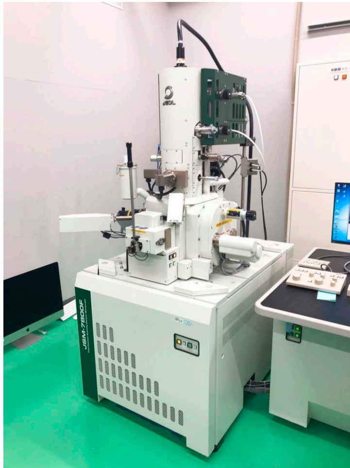
図 3.2.1-1 EDX 付き日本電子製走査型電子顕微鏡 (SEM)
