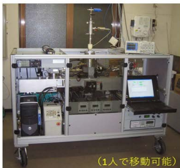
図 3.3-1 ATOFMS の (上) 概略図と (下) 実機写真
