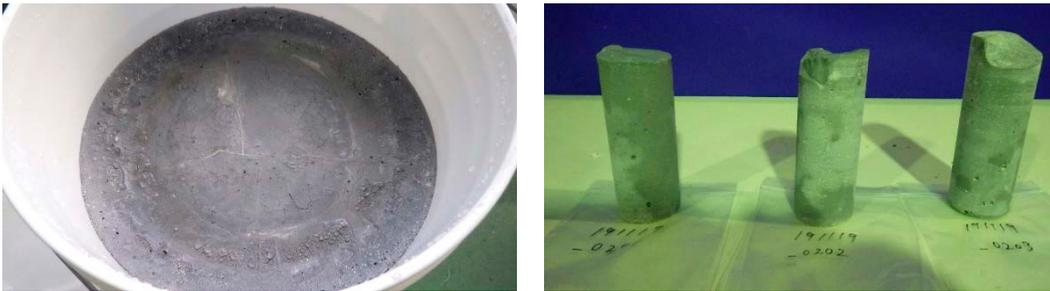
図 3.3-12 養生後の試験体 No.3 (左：外観、右：コア抜き後の試料)
