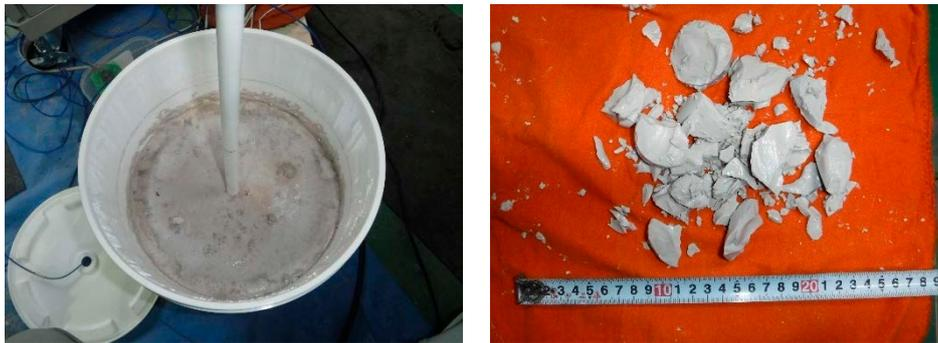
図 3.3-13 養生後の試験体 No.4 (左：外観、右：コア抜き後の試料)
