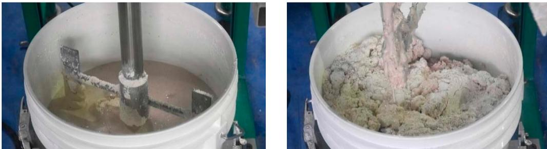
図 3.3-2 Metastar501 の混錬の様子（左）3/4 投入後、（右）全量投入後
