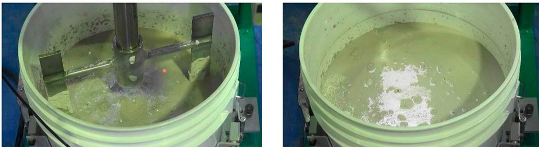
図 3.3-3 ソブエクレの混錬の様子（左）3/4 投入後、（右）全量投入後
