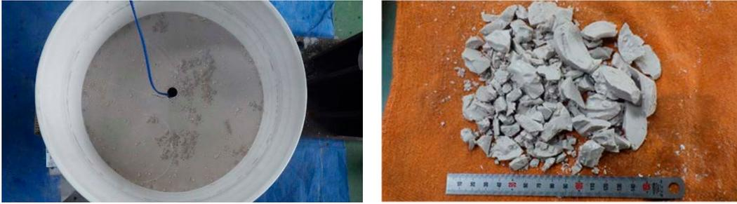
図 3.3-11 養生後の試験体 No.2 (左：外観、右：コア抜き後の試料)
