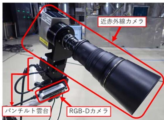
図 3-5 構築した計測システム
