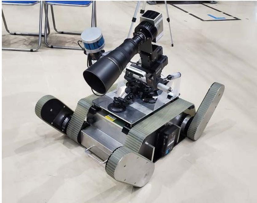
図 3-19 新型ベルトを装着した実験用レスキューロボットの外観
