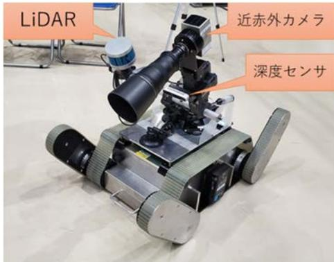
図 3-22 実ロボットのセンサ構成
