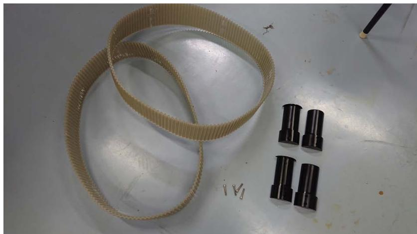
図 3-18 ベルト幅の広いクローラベルトとアタッチメント
