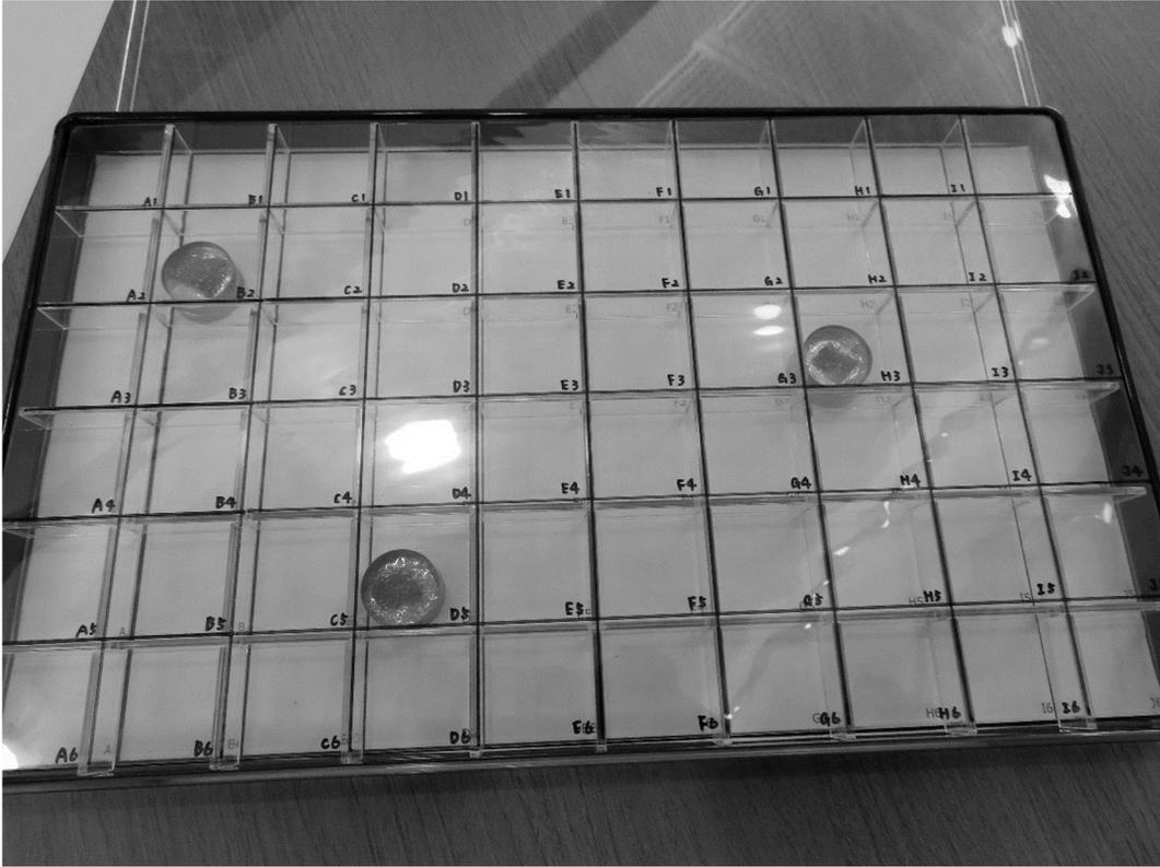
図 4.8-1 実習で使用する模擬汚染盤
