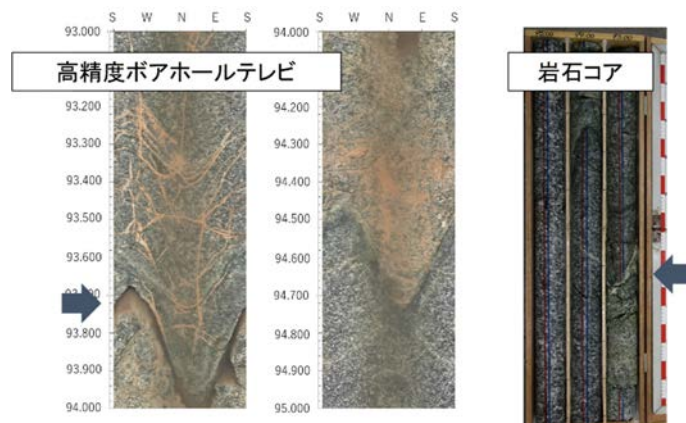
図 3.3.1-4 ボーリング調査で観察された割れ目
