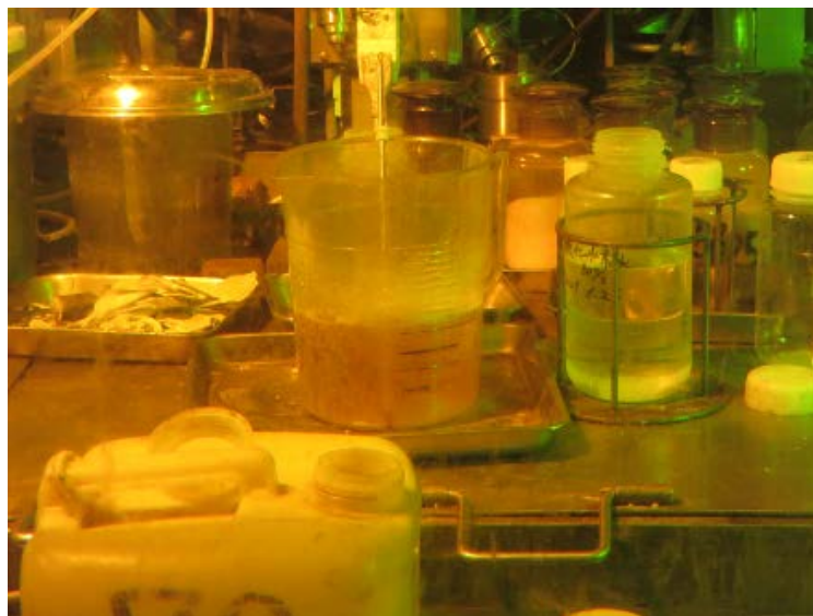
図 3.4-2 セル内での乳酸分解作業の様子
