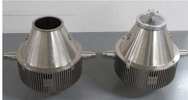
粉末搬送容器（蓋設置前）
