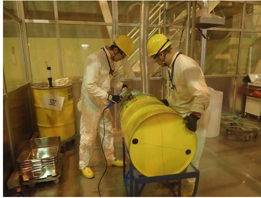
図 2.4-3 廃ドラム缶の切断作業
