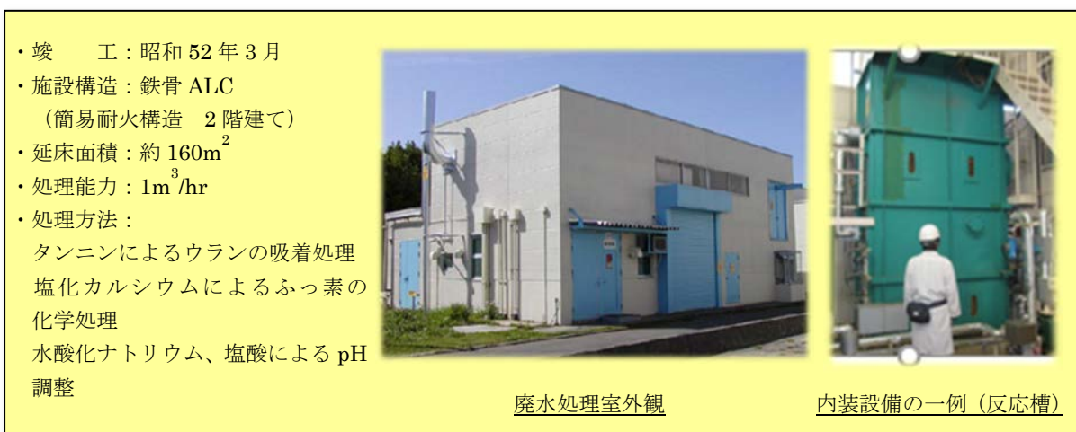
図 2.1.6-1 廃水処理室の概要
