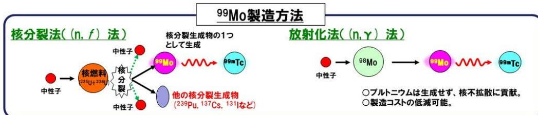
ウラン ( $^{235}\text{U}$ ) を用いない放射化法による $^{99}\text{Mo}$ 製造技術を確認し、 $^{99}\text{Mo}/^{99\text{m}}\text{Tc}$ 国産化を目指し、 $^{99}\text{Mo}$ を安定に供給することが重要。
