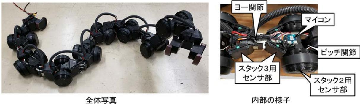
図 3.4-1 センサを搭載した多連結移動ロボット
