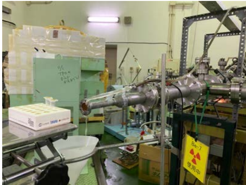
図8 ペレトロンによる中性子線照射
