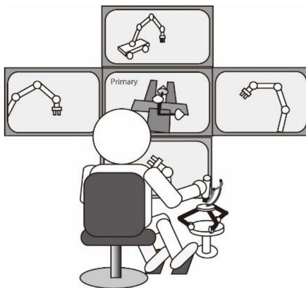
図 3.2-8：複数画面を有する遠隔操縦システムの基本コンセプト
