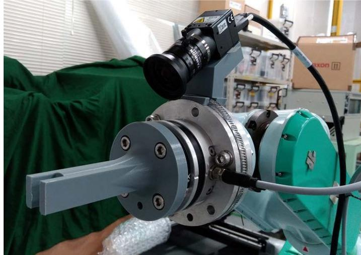
図 3.2-11：ロボット手先カメラ
