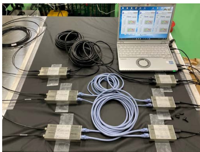
図 15 多チャンネル読み出し回路を用いた広ダイナミックレンジ TOF センサ
