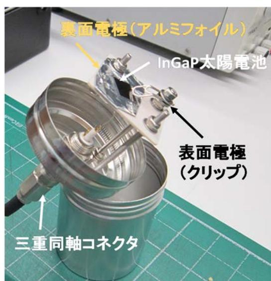
図 3.2-9 作製した線量計プロトタイプの写真
