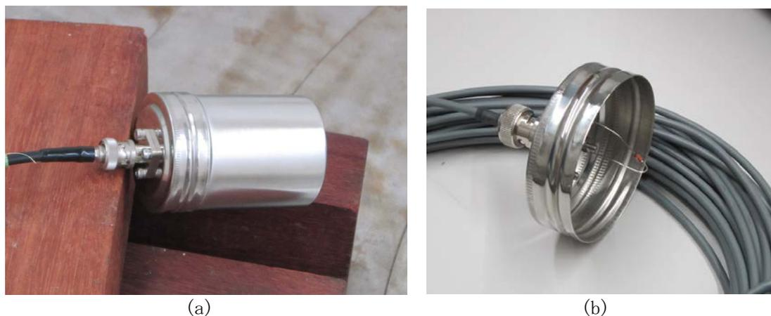
図 3.2-1 ケーブル端を電氣的に遮蔽するためのステンレス鋼製の保存缶
