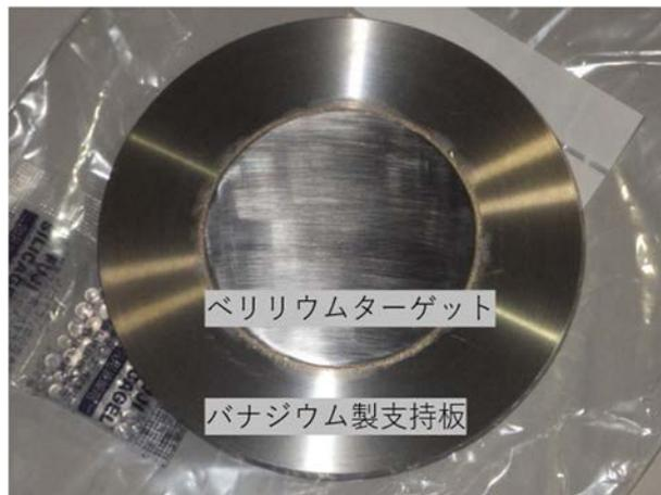
図 3.3.2-3 中性子発生ベリリウムターゲットおよびバナジウム製ホルダー
