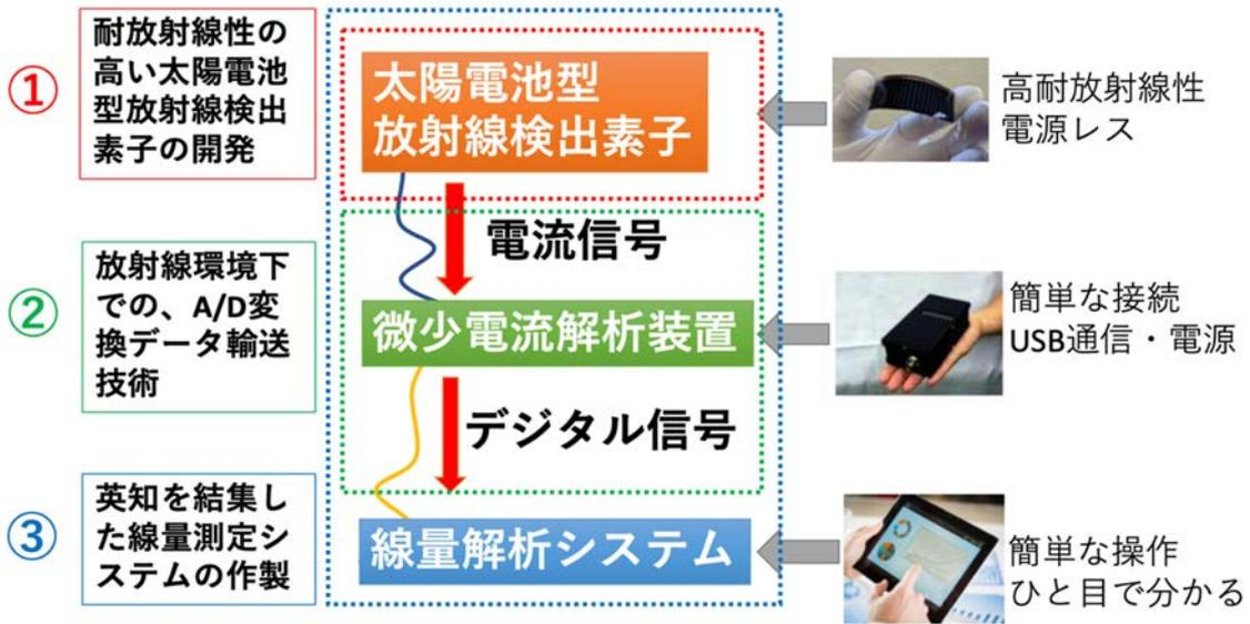
図 2.1-1 線量計開発に関する概要図
