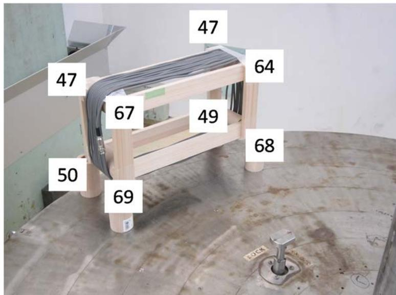
図 3.2-5 ガンマ線励起電流測定のために木枠に巻いたケーブルと各場所における線量率
