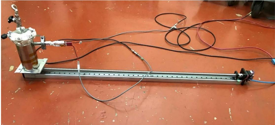
図 3.3.1-3 第3照射室における照射誘起電流測定時のレイアウト
