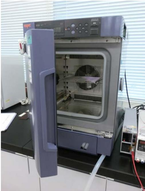
図 3.1.2-4 耐湿度性試験に用いた恒温恒湿試験装置 (ESPEC SH-221)
