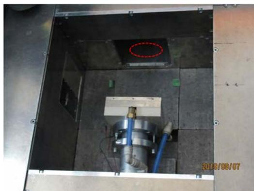
図 3.3.2-8 遮蔽体を開放して露出させた陽子ビームライン末端部
