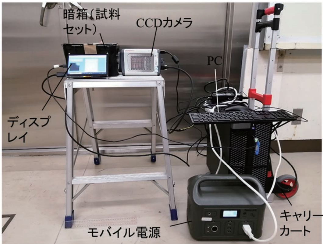
図 3. 1. 3-10 開発したα線イメージング装置のモバイル電源での作動確認
