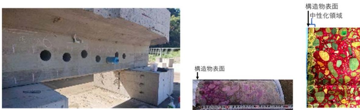
図 3.3-11 実構造物 (RC 橋の橋桁) からのコアサンプル
