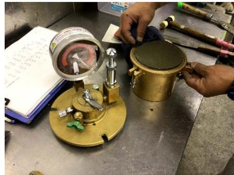
(d) モルタル混練後の空気量測定状況
