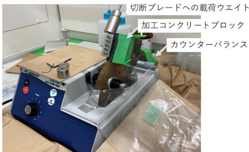
図 3.3-10 4×6×6 cm コンクリート試料の切断状況
