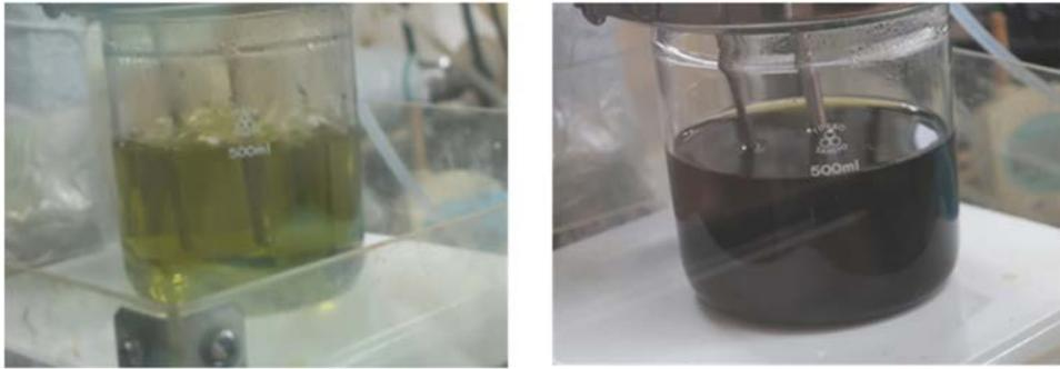
図 3.3-18 混合酸化物 (MOX) の溶解
