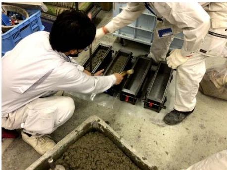
(e) コンクリートの型枠への打設状況
