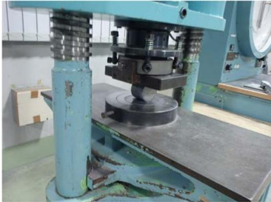
(a) 割裂引張によるひび割れ導入状況
