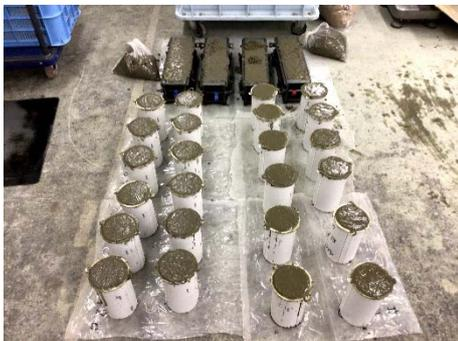
(g) コンクリートの打設後状況
