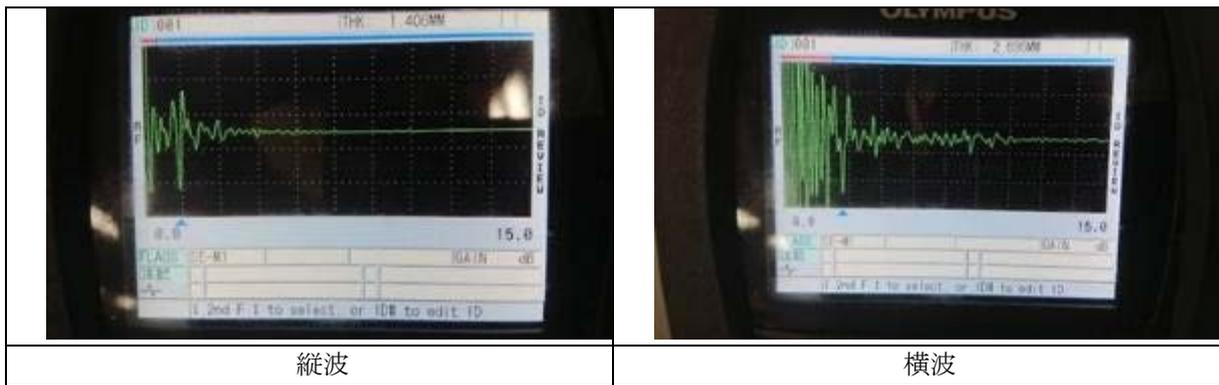
図 3.1-5 超音波伝搬波形の一例
