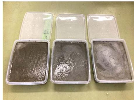
(f) モルタルの成型容器への打設後状況
