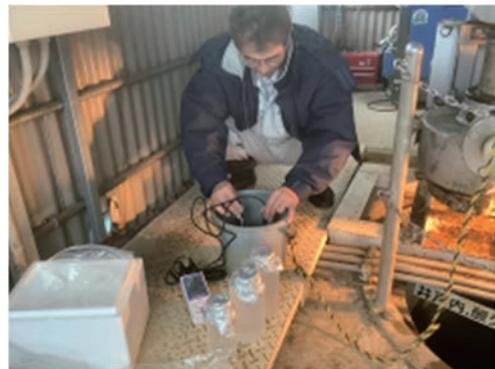
サンプル水の溶存酸素、pH、温度の測定
