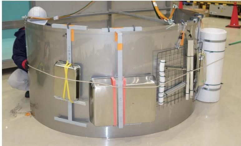
図 3.2.2-8 ペDESTAL外壁模擬体表面に貼付した配電盤等の模擬材
