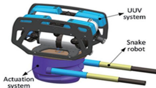
図 3.4-1 連続体のスネーク型マニピュレータを統合した UUV の概念図
