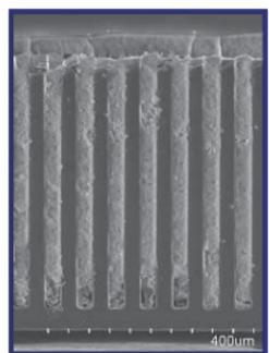
図 3.1.1-5 MSND パッケージの写真と多重構造の内部写真
