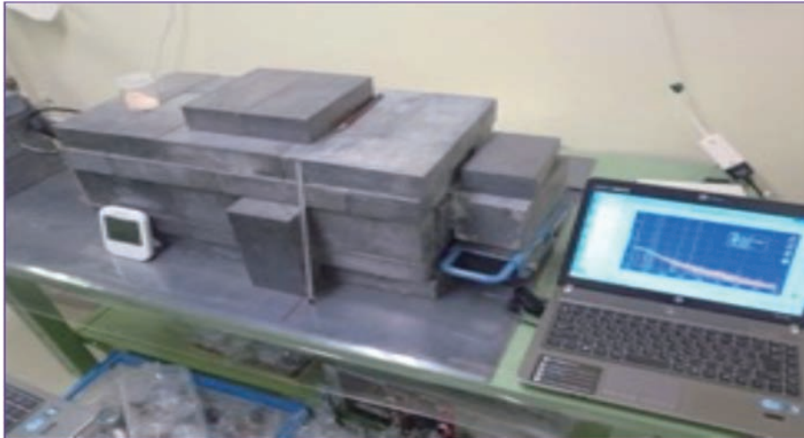
図 3.1-7 測定装置 高純度 Ge 半導体検出器を 10 cm の厚さの鉛で遮蔽
