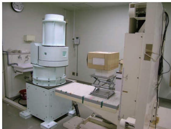
図 3.2-8 A/J マウスへの Cs-137 \gamma 線外部照射装置と照射条件
