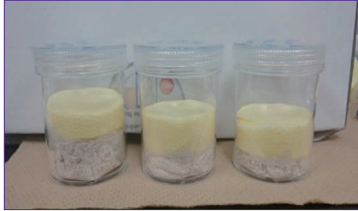
図 3.1-6 測定試料 均一化して U8 型容器に詰め、上面は発泡スチロールで固定
