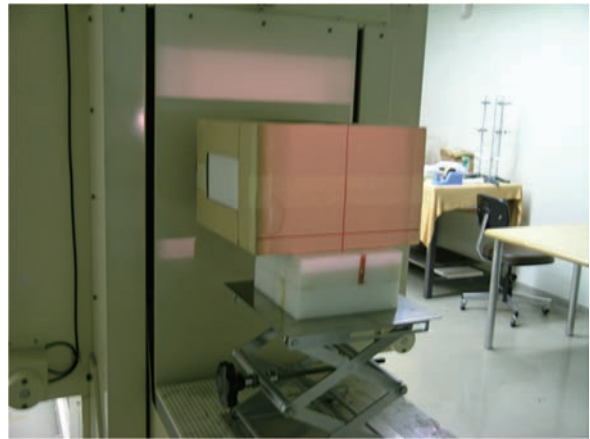
図 3.2-7 A/J マウスへの Cs-137 \gamma 線外部照射
