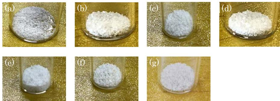
図 3.1.1-4 アルカリ 1 水溶液の濃度を変化させて作製した材料の写真
