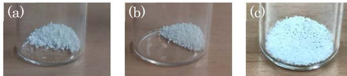
図 3.1.1-7 アルカリ 2 水溶液の濃度を変化させて作製した材料の写真
