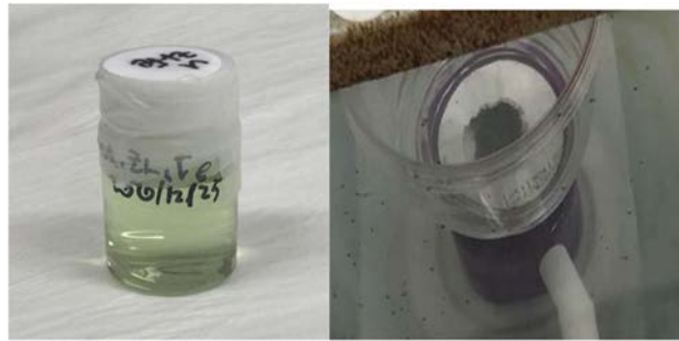
図 3.1-17 \text{UO}_2\text{-ZrO}_2\text{-Fe}_3\text{O}_4 混合物試料塩素化生成物の溶解試験後の溶液及び不溶解残渣
