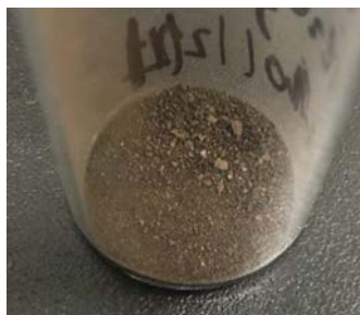
図 3.1-15 混合試料の塩素化試験後生成物
