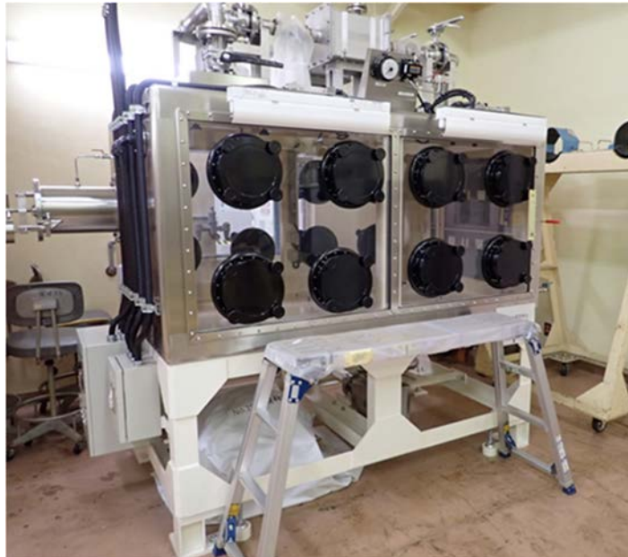
図 3.1-1 整備した放射性物質取扱用グローブボックスの写真
