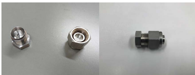
(a) プラグ(左)とキャップ(右) (b) 両者を組み立てた図 図 3.1-6 反応容器に用いるスウェジロックキャプセル
