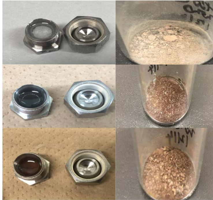
図 3.1-10 酸化ジルコニウムと酸化鉄の塩素化実験の写真 上から、酸化ジルコニウム ( \text{ZrO}_2 )、酸化第一鉄 ( \text{FeO} )、酸化第二鉄 ( \text{Fe}_2\text{O}_3 ) 左は加熱する前、右は加熱後の生成物
