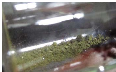
図 3.1-7 400 °C 4 時間での二酸化ウランの反応生成物の写真
