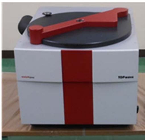
図 3.1-2 整備したマイクロ波加熱装置の写真
