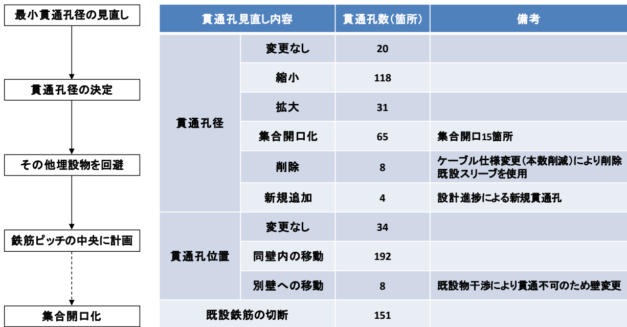
図 1.1.4-8 鉄筋等の埋設物調査結果を踏まえた貫通孔の径及び位置の見直し結果
