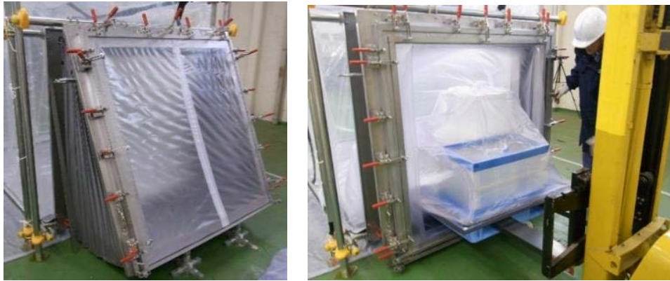
図 1.2.8-11 大型機器類のバッグイン・バッグアウト試験
