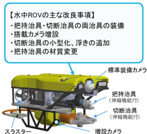
図 1.1.5-1 水中 ROV の主な改良点
