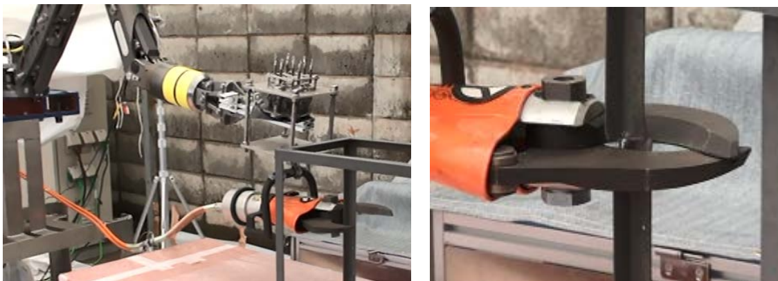
図 1.2.8-5 油圧カッターを装備したロボットアームによる切断能力確認試験
