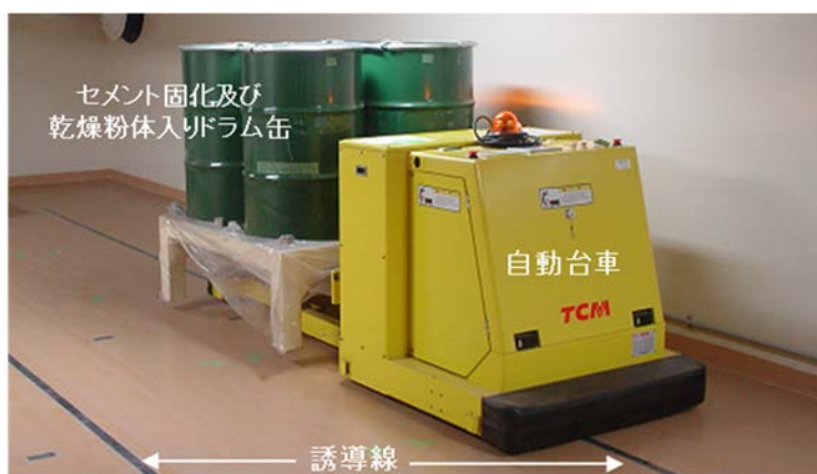
図 1.1.4-5 LWTF に設置されている自動台車
