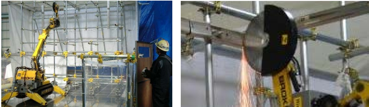
図 1.2.8-4 ディスクソーを装備した小型重機による切断能力確認試験
