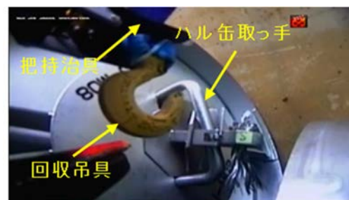
ハル缶への吊具取付け
