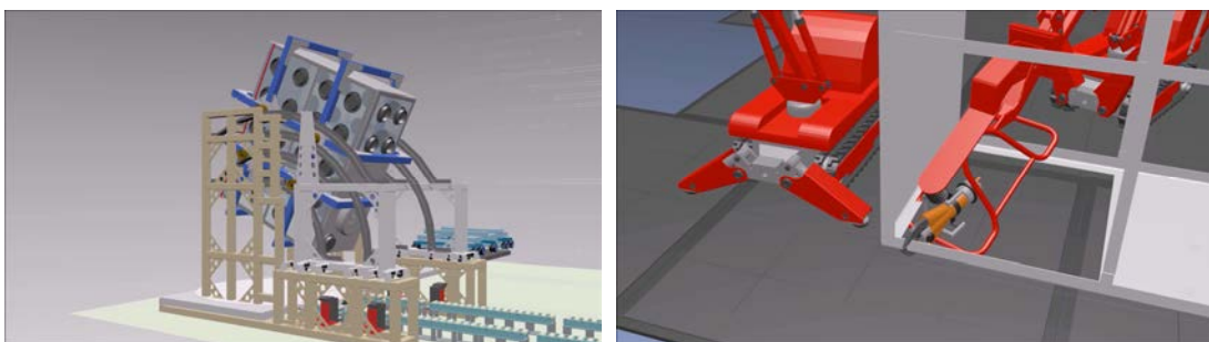
図 1.2.8-1 GB 横転装置及び遠隔操作機器による GB フレームの切断 (イメージ)
