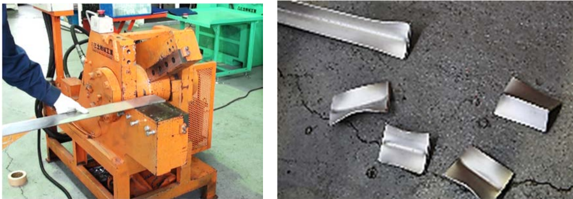
図 1.2.8-9 油圧シャーによる切断能力試験
