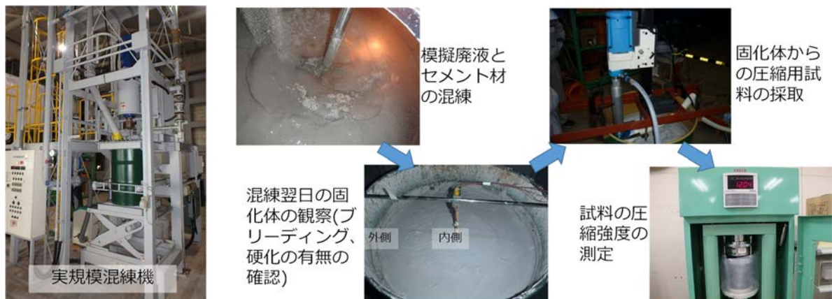
図 1.1.4-6 実規模大の混練試験の概要
